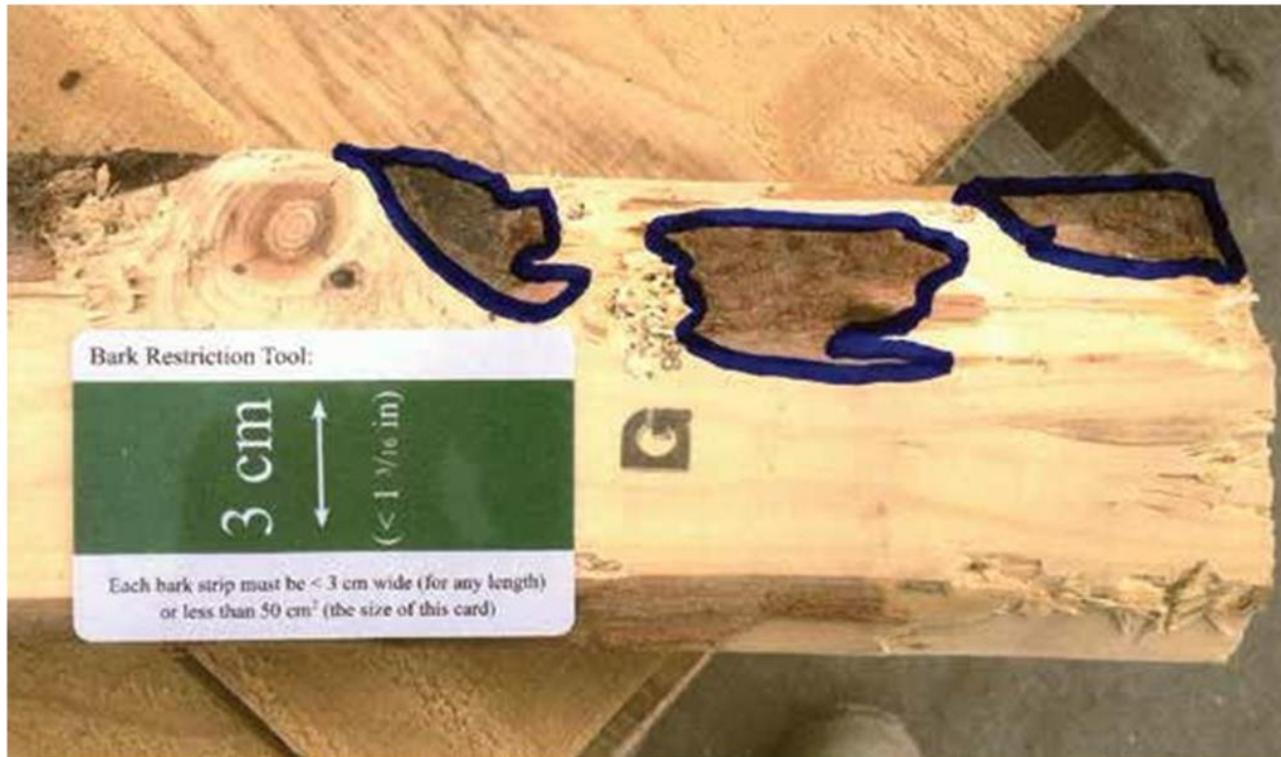
La corteza se ha raspado lo suficiente como para que cada sección de la corteza no supere el tamaño de la tarjeta.
