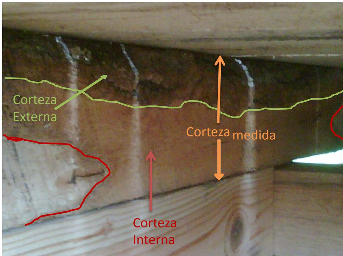
Contraste de corteza para madera dura. Se miden tanto la corteza interna como la externa para determinar la conformidad. En este ejemplo, la corteza se mide en todo el ancho del tablero (mas que 1 3/16") y no seria conforme.
