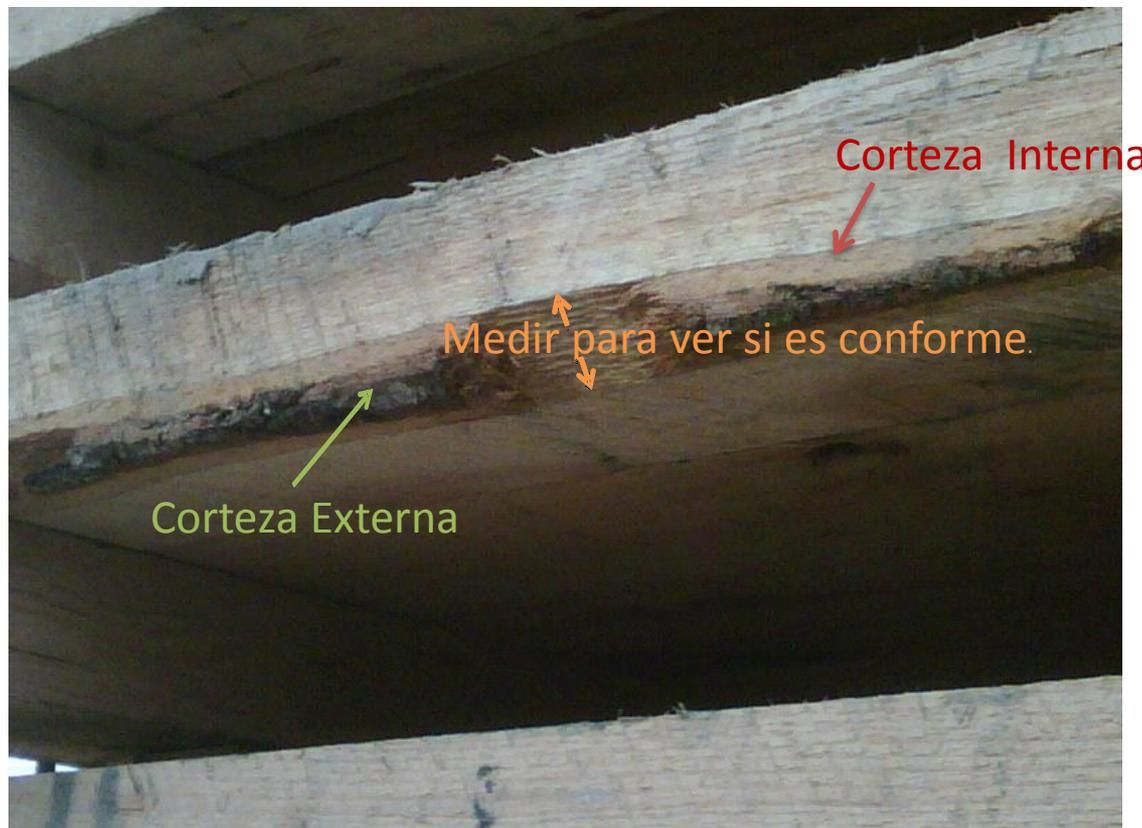
Contraste de corteza para madera dura. Se miden tanto la corteza interna como la externa para determinar la conformidad. La corteza no puede ser mas que  $1 \frac{3}{16}$ ". Esto no es conforme a menos que la area conectada de la corteza es menos que 50 sq. cm.
