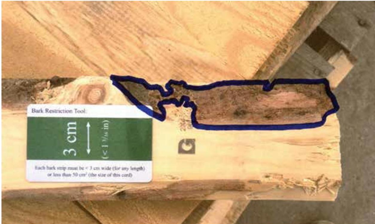
La corteza es mas ancha que la “corte de la tarjeta” y la area total supera el tamaño de la ventana.
