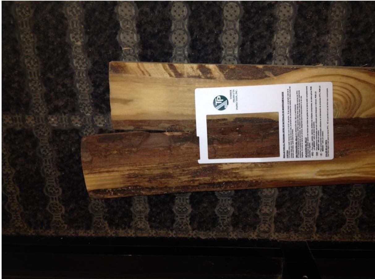
La corteza es mas ancha que la “corte de la tarjeta” y la area total supera el tamaño de la ventana.
